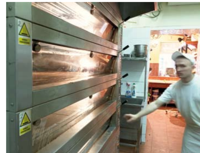
W żywieckiej piekarni-cukierni pracuje czterokomorowy piec Gwarek Plus, który mieści w sumie 16 blach 600 x 400 mm. To z niego unosi się zapach, który wabi klientów do sklepu. Fot. PHU GAŁUSZKA
